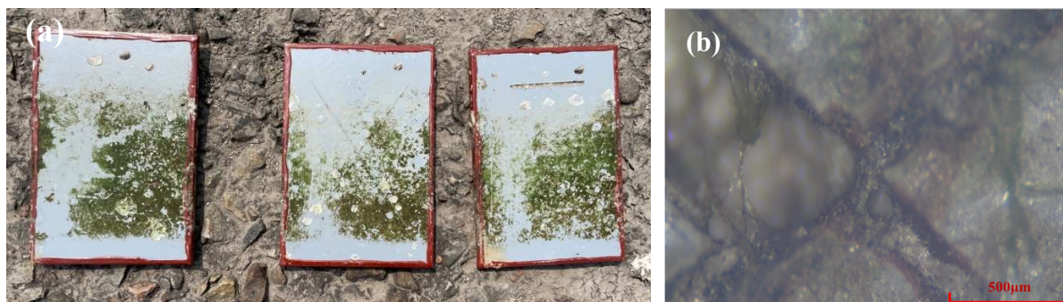
圖 8 (a) YCP-7 試片第 10 個月，(b) 光學顯微鏡觀察。 Figure 8 (a) YCP-7 test pieces for the tenth month, (b) Optical microscopy observation.
