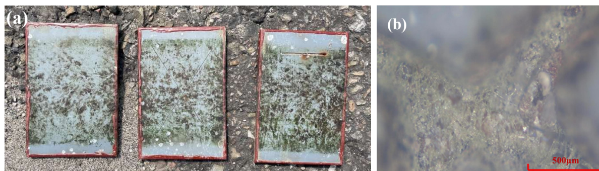
圖 7 (a) YCP-6 試片第 10 個月，(b) 光學顯微鏡觀察。
