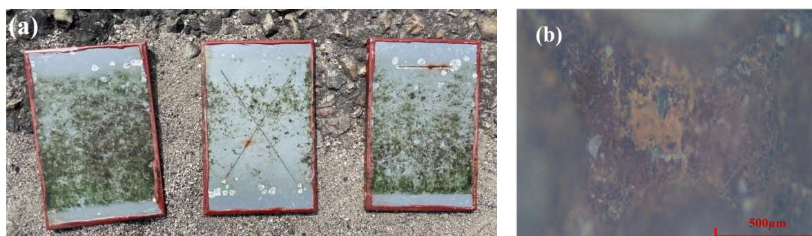
圖 6 (a) YCP-5 試片第 10 個月，(b) 光學顯微鏡觀察。
