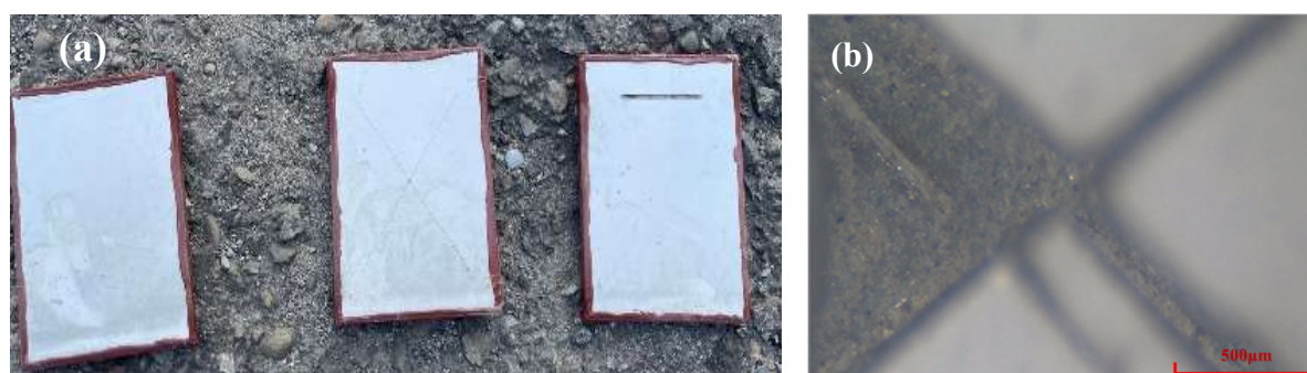
圖 3 (a) YCP-2 試片第 10 個月，(b) 光學顯微鏡觀察。 Figure 3 (a) YCP-2 test pieces for the tenth month, (b) Optical microscopy observation.
