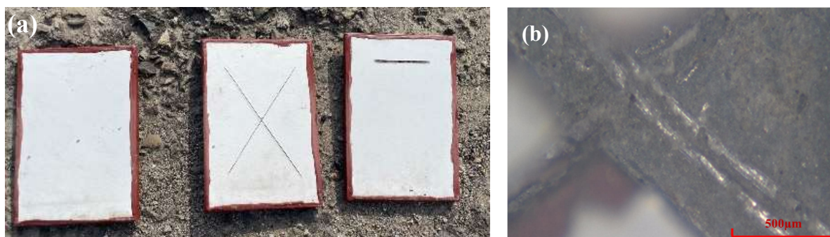
圖 2 (a) YCP-1 試片第 10 個月，(b) 光學顯微鏡觀察。 Figure 2 (a) YCP-1 test pieces for the tenth month, (b) Optical microscopy observation.
