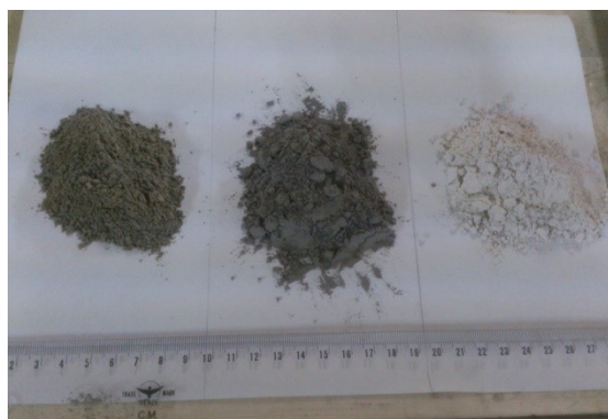
圖 1 水泥、飛灰及爐石之外觀。 Figure 1 Appearance of cement, fly ash and slag.
