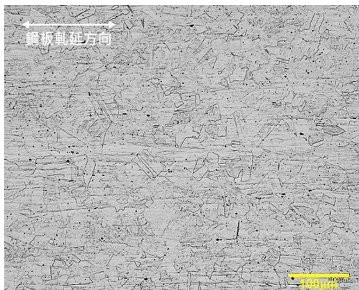
圖 8 廢水排放管線之金相顯微組織。 Figure 8 Metallographic picture of the pipe.
