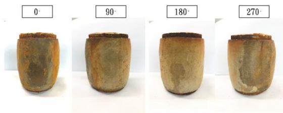
圖 2 A 試片進行冷熱交變實驗及沖蝕實驗之循環測試第四次之各角度觀察。
