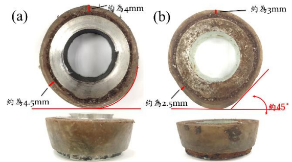
圖 3 A 試片橫切剖面與厚度觀察(a)原始試片(b)第四次。
