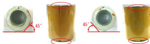
圖 8 B 試片進行冷熱交變實驗及沖蝕實驗之循環測試第六次之上下層龜裂情形。
