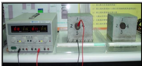
圖 6 加速腐蝕試驗。 Figure 6 Speeding Corrosion Test.
