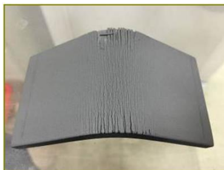
圖 21 WC-Cr-Ni 塗層彎曲測試結果。 Figure 21 WC-Cr-Ni Thermal spray coating Bend Test Results.
