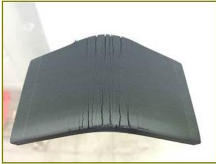
圖 16 Ni-Cr 塗層彎曲測試結果。 Figure 16 Ni-Cr Thermal spray coating Bend Test Results.
