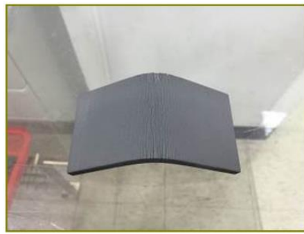
圖 20 WC-Co-Cr 塗層彎曲測試結果。 Figure 20 WC-Co-Cr Thermal spray coating Bend Test Results.
