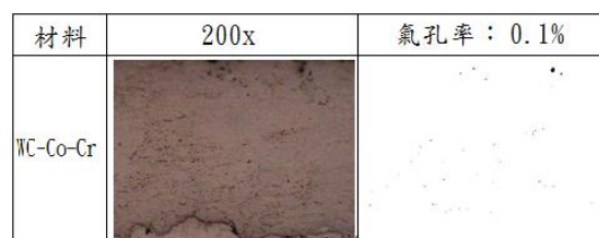
圖 13 WC-Co-Cr 熔射塗層斷面金相&氣孔率。
