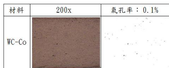
圖 12 WC-Co 熔射塗層斷面金相&氣孔率。
