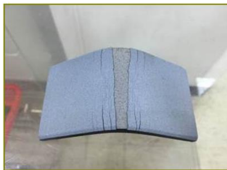
圖 18 \text{Al}_2\text{O}_3\text{-TiO}_2 塗層彎曲測試結果。 Figure 18 \text{Al}_2\text{O}_3\text{-TiO}_2 Thermal spray coating Bend Test Results.
