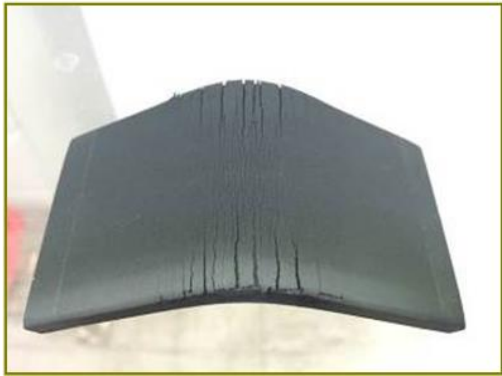
圖 22 \text{Cr}_2\text{O}_3 塗層彎曲測試結果。 Figure 22 \text{Cr}_2\text{O}_3 Thermal spray coating Bend Test Results
