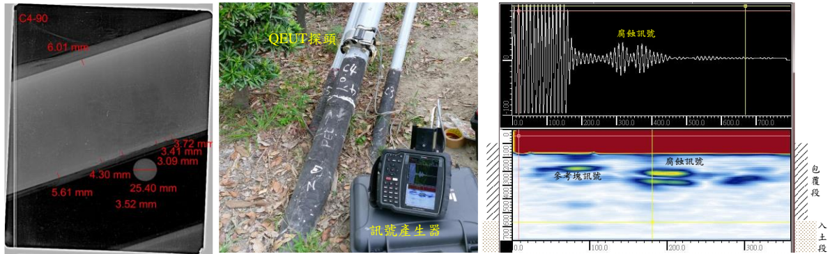
圖 3 應用定量電磁超音波於出入土段檢測案例。 Figure 3 Case study: soil interface corrosion inspection using QEUT.
