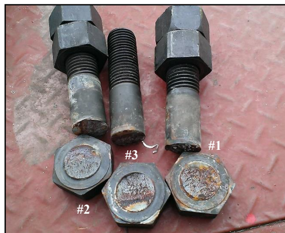
圖 2 現場取下斷裂螺栓之外觀及其編號。
