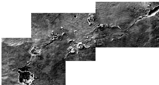
圖 17 304_SEN 於 80°C、1000 小時實驗後，孔蝕與裂縫之 SEM 觀察結果(1000X)。 Figure 17 SEM image of 304_SEN at 80°C after 1000 hours (1000X).
