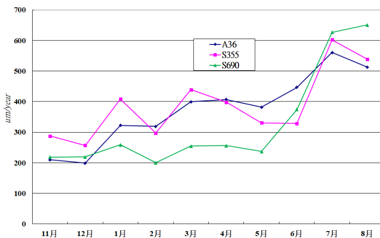
圖 8 潮間帶三種腐蝕探針 104 年 11 月至 105 年 8 月各月份之腐蝕速率變化圖。 Figure 8 The trends of the three probes corrosion rates at the tidal zone from Nov. 2015 to Aug. 2016.
