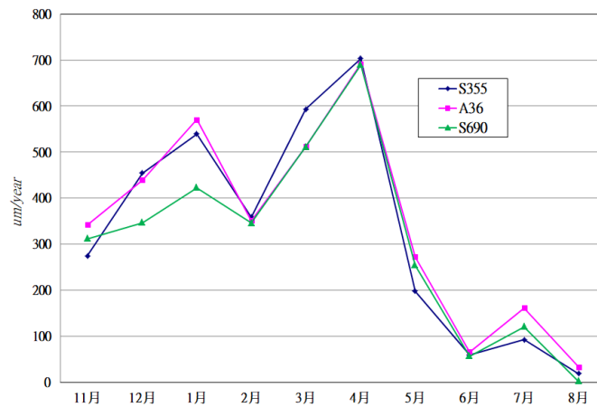
圖 6 平台上三種腐蝕探針 104 年 11 月至 105 年 8 月各月份之腐蝕速率變化圖。 Figure 6 The trends of the three probes corrosion rates on the platform from Nov. 2015 to Aug. 2016.
