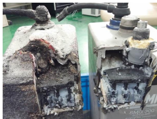
圖 2 切開部分外裝容器後破損(左)與未破損對照組蓄電池(右)。
