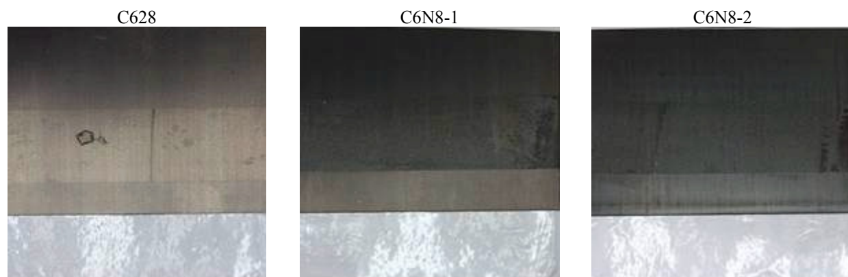
圖 5 C628、C6N8-1 與 C6N8-2 塗膜鋼片之退火附著性(以 Scotch 600 膠帶黏貼後撕下，下方為撕下的膠帶)。 Figure 5 Tape (Scotch 600) test results for the annealed ES with the coating: C628, C6N8-1 and C6N8-2. (upper: the sample with tape torn off; bottom: the tape)
