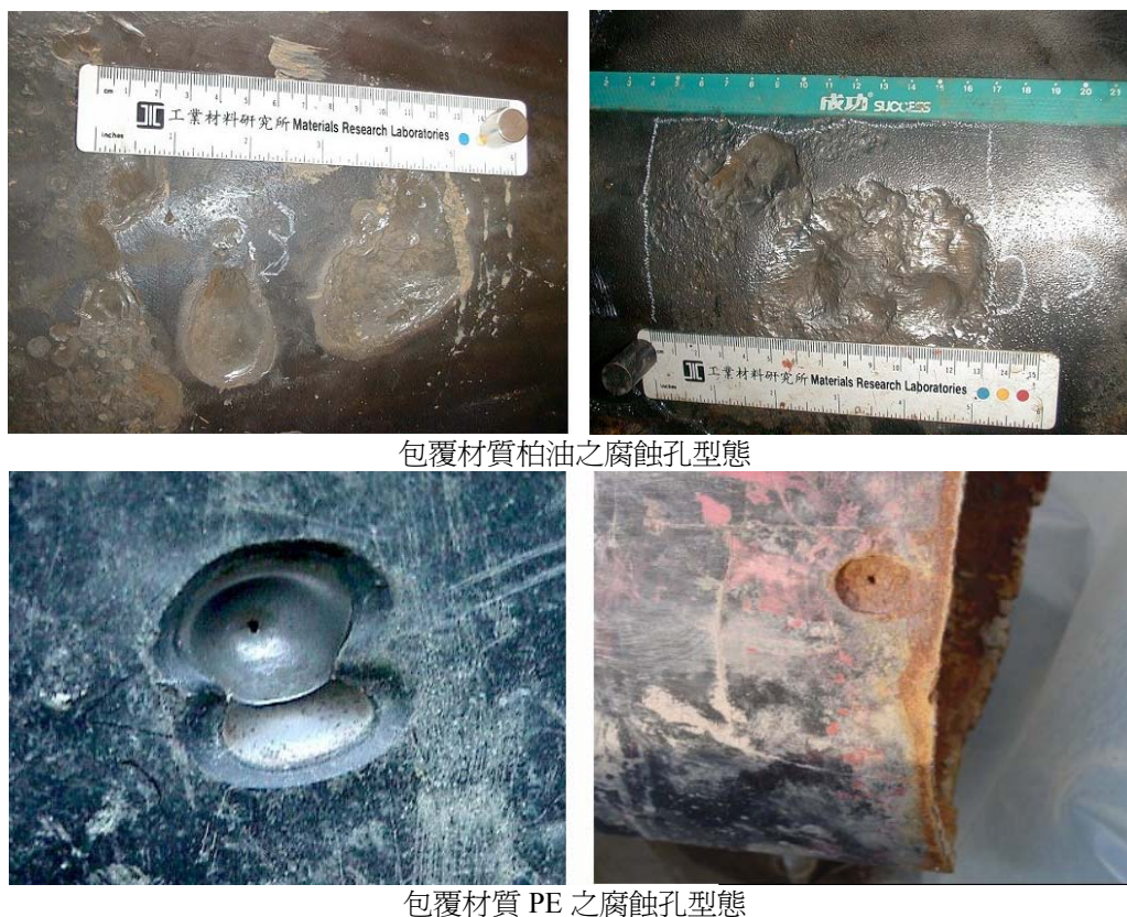
圖 7 不同包覆材料造成不同型態腐蝕孔。
