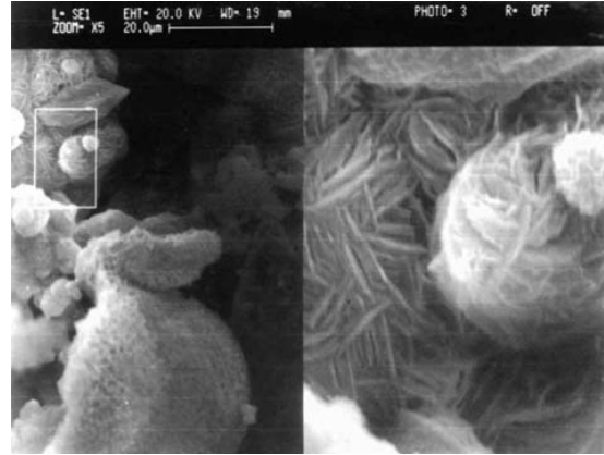
圖12 混凝土受硫酸鎂侵蝕形成群聚花瓣結構SEM圖。
