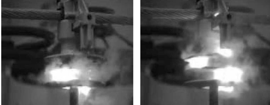
圖19 樣品 A-2 ESDD 等效鹽霧試驗放電影像觀測(0.35 mg/cm 2 )。
