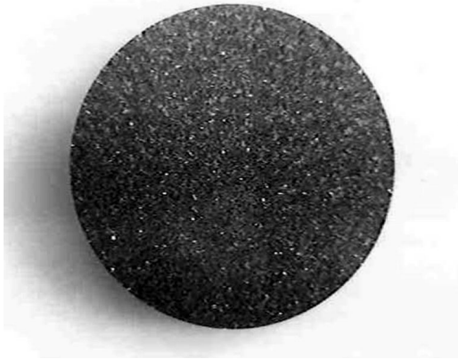
圖10. 利用中磷無電鍍鎳表處之 Nd-Fe-B 膠磁施予水性PU溶液浸泡，再經 240 小時環境試驗 (90% RH, 80°C) 後之外觀
