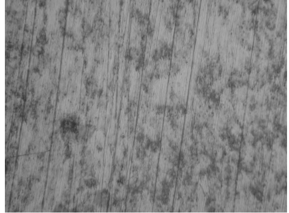
圖8. 經 600°C 熱處理 8 小時試片之顯微照片， X1500 倍。 Fig. 8 Micrograph of thermal-sprayed copper layer treated at 600°C for 8 hours, X1500.
