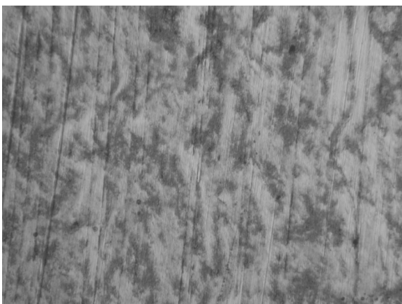
圖7. 經 400°C 熱處理 8 小時試片之顯微照片， X1500 倍。 Fig. 7 Micrograph of thermal-sprayed copper layer treated at 400°C for 8 hours, X1500.
