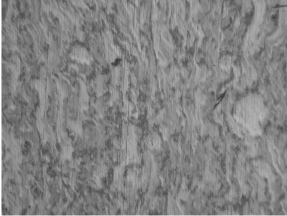
圖6. 經 200°C 熱處理 8 小時試片之顯微照片， X1500 倍。 Fig. 6 Micrograph of thermal-sprayed copper layer treated at 200°C for 8 hours, X1500.
