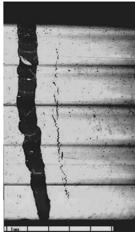
圖 13. 為暴露區內所產生的斷斷續續之唯一裂縫。
