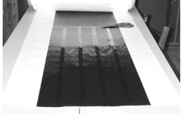
圖6. 編織之碳纖維貼布材料圖 Fig.6 The woven CFRP.
