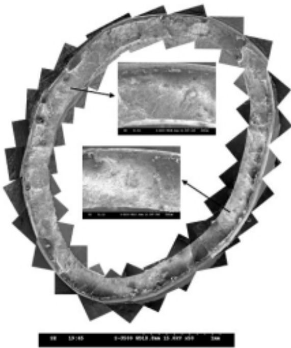
圖 5 管材斷面SEM金相組織圖
