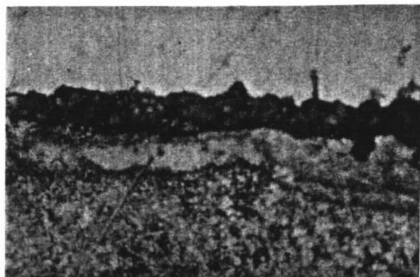
圖 14 碳鋼在 pH=9, [NaNO<sub>3</sub>]=0.2M 之水溶液中, 鏡照相圖
