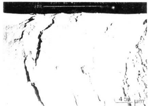
照片五 試片N5之表面 Photo. 5 Surface cracks of N5 specimen.
