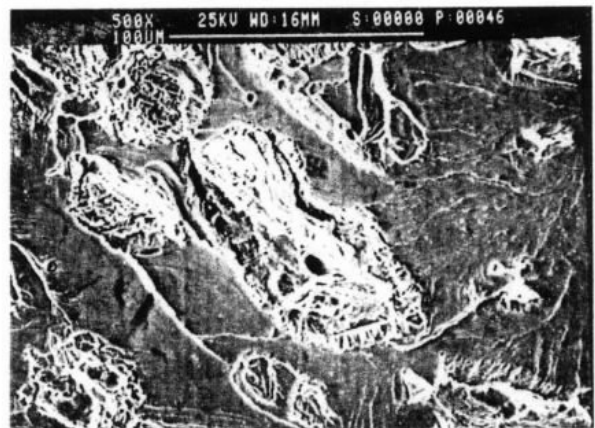
照片九 試片 A8之斷面觀察 Photo. 9 Fracture surface of A8 specimen.
