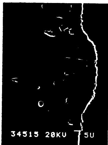
圖 3. Ni-28%Cr 合金在 1000 °C 純氧下經 100 小時氧化後，孔洞在底材和鏽皮界面和底材內生成。<sup>(9)</sup>
